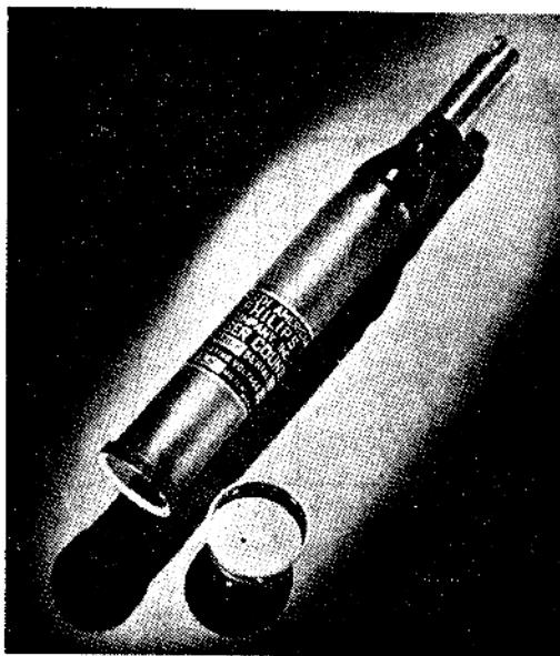
第12図 Norelco 回折装置に用いられている 62019 型ガイガー計数管、(管及び心線に平行に) X線の入る窓は厚さ 0.012 mm の雲母で作られている。気体充填物は圧力約 55cmHg のアルゴンと、抑制剤 (quenched agent) として圧力数 mmHg の塩素である。動作電圧は 1400 から 1500 ボルトで、プラトーは少くとも 300 ボルトに亘っている。
