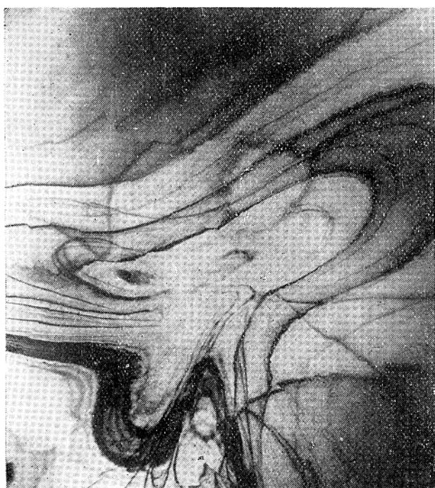
Photo. 2. アンニールしたアルミニウム単結晶の薄片
