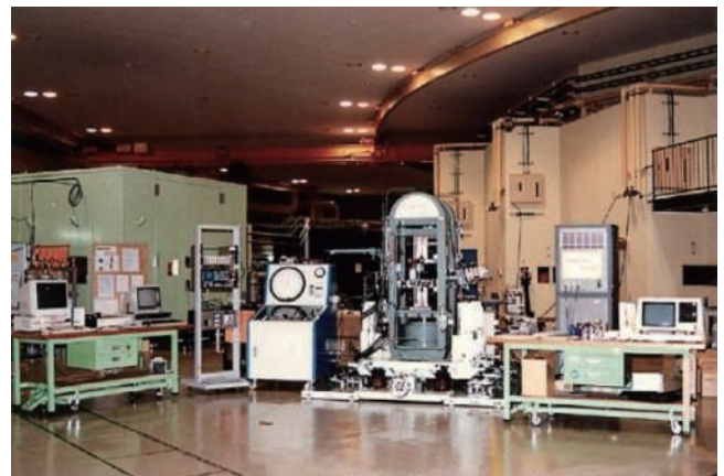
図1 PF, BL4C前に並べられた初期のMAX80の全システム
