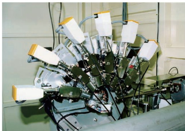
図4 PFのBL-4B2に設置された多連装粉末回折計。各アームとも、試料側からソーラーズリット、アナライザー結晶、真空パス、シンチレーション検出器が設置されている。
