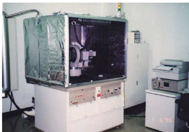
図1 窒素冷氣吹き付け型低温測定装置を取り付けた四軸型単結晶X線回折装置。冷却効率を上げるために装置全体のケースをシールドしている。
