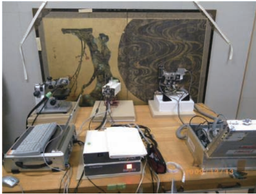
図2 屏風を分析中のデジタル顕微鏡, p-XRF, p-XRD
